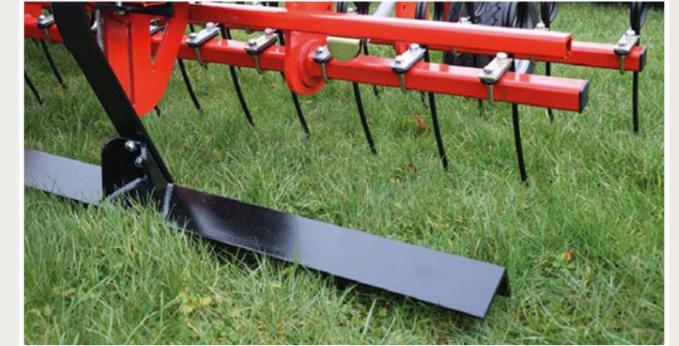
Als Einebnungswerkzeuge stehen dem Kunden entweder eine 3-teilige Planierschiene oder das Spring-Board zur Verfügung.
