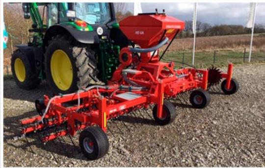
Der standardmäßig verbaute rückwärtige Koppelbock bietet zudem die Möglichkeit, den Grass-Combi in Kombination mit einer gezogenen Walze zu nutzen. Hier bietet sich der HE-VA Tip-Roller als optimale Ergänzung an.
