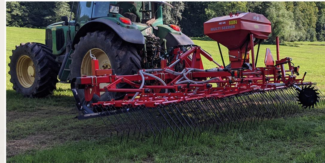
Bis zu einer Arbeitsbreite von 9m steht dem Kunden eine schwere Planierschiene zur Verfügung, welche Maulwürfhügel u.ä. einebnet. Für größere Arbeitsbreiten sind am Zinkenträger befestigte Planierbleche verfügbar.
