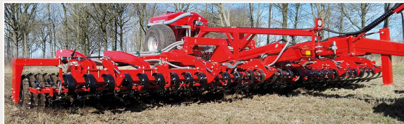
Durch das SAT-System verfügt der Grass-Roller über eine optimale Gewichtsverteilung, zudem entsteht durch die pendelnd aufgehängten Seitensektionen eine herausragende Boden Anpassung – entscheidend gerade im kuppigen Gelände.
