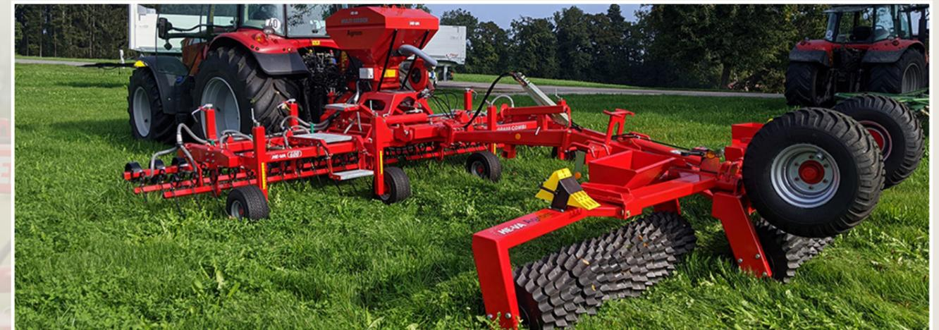
Das Walzen ist zudem im Frühjahr auf den Flächen notwendig, welche im Winter durch Frost hochgefroren sind. Durch den gleichmäßigen Bodendruck der Walze wird der Bodenschluss wieder hergestellt und etwaige Unebenheiten nivelliert. Wird zudem eine Walze mit den HE-VA Sternringen genutzt, so kommt es zudem durch das spezielle Walzenprofil zu einer Bestockungsanregung bei den Pflanzen.
