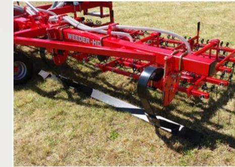
Der Weeder HD kann wahlweise mit 9mm oder 7mm starken Zinken ausgerüstet werden, wobei auch beide Zinkenstärken kombiniert genutzt werden können. Da der Zinkenwechsel durch ein Stecksystem werkzeuglos erfolgt, kann der Strigle einfach von 9mm auf 7mm Zinken umgerüstet werden. Dadurch ergibt sich die Möglichkeit, das Gerät sowohl als Grünland- wie auch als Ackerpflgestriegel zu nutzen.
