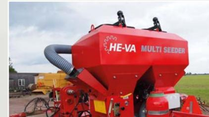
Für spezielle Einsatzzwecke können bis zu drei Multi-Seeder-Einheiten mit einem Bedienterminal verwaltet werden. Dieses ermöglicht z.B. die gleichzeitige Ausbringung verschiedener Saatgutarten.
