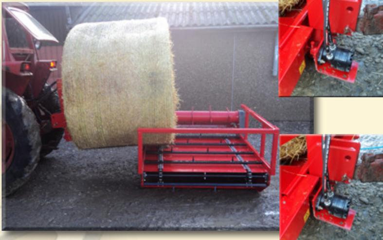
Einer der technischen Feinheiten des Gerätes ist die zwei integrierten Spieße. Sie werden für die Abholung der Ballen und die Anordnung auf dem Abwicklungstisch verwendet. Danach werden sie als Schnellkuppler für das Tisch verwendet.
