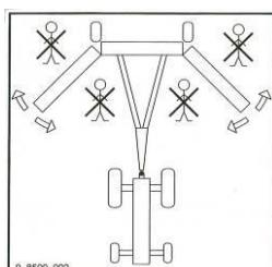
Figyeljen arra, hogy senki ne tartózkodjon a gép veszélyeztetett zónáján belül nyitás és összecsukás idejében.
