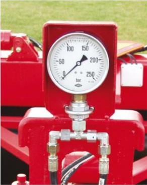
Hierdurch kann der Fahrer die hydr. Gewichtsübertragung einstellen, um eine gleichmäßige Rückverfestigung in der ganzen Arbeitsbreite zu erreichen. KingRollers Hauptrahmen ruht auf den zwei Innensegmenten (O) vgl. Foto. Durch dieses SAT-System wird der notwendige Teil von dem Gewicht der Walze auf das Mittelsegment und die Außensegmente übertragen (--□) vgl. Foto
