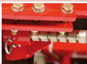
Per i terreni privi di pietre e per dissodare pochi ettari alla volta, la scelta non può che ricadere sulla protezione contro le pietre Quick-Push. Quando il dente del dissodatore entra in contatto con una pietra, una delle 8 scanalature viene tagliata automaticamente. Per ripartire, rimuovere il perno senza utilizzare utensili e spingere il bullone per far fuoriuscire una nuova scanalatura.
