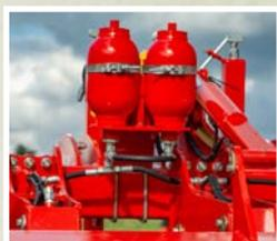
Il Grass-Tiller è disponibile con protezione idraulica e Quick-Push. La protezione idraulica contro le pietre è la scelta migliore per l'utilizzo su terreni rocciosi. Consiste di un cilindro posizionato sui denti che li solleva automaticamente al contatto con le pietre, per poi tornare automaticamente in posizione.
