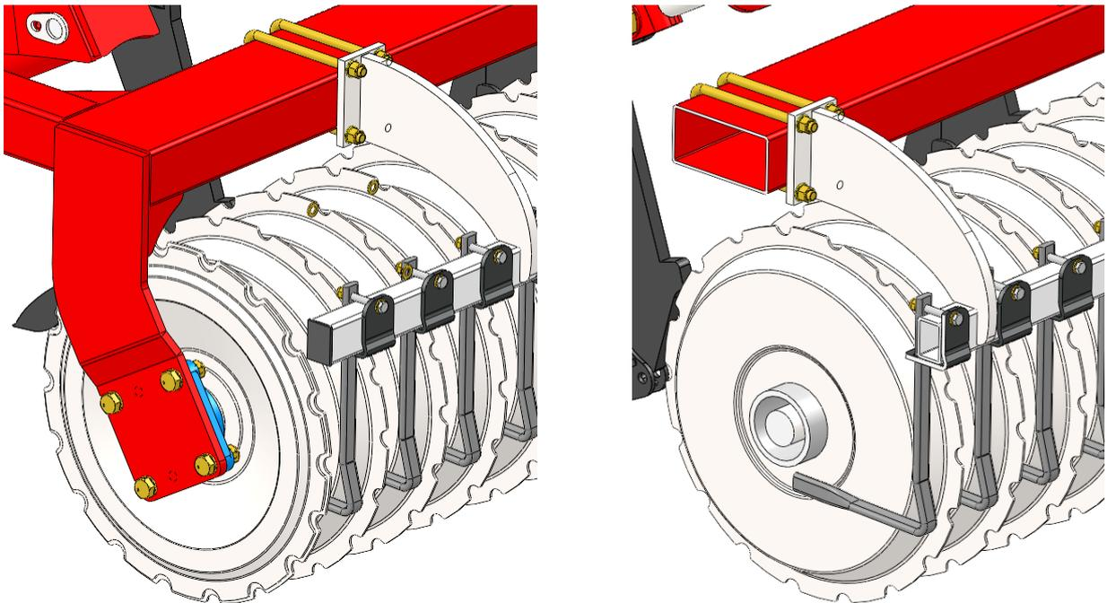
Der Sub-Tiller ECO ist mit Abstreifern aus Edelstahl zwischen den Packerringen bei der V-Profilwalze versehen.
