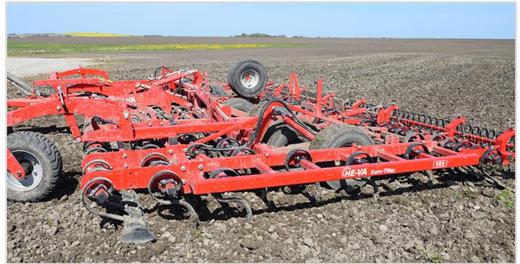
Euro-Tiller 9,00 m avec dents 65x12 mm, rangée supplémentaire 65x12 mm, Spring-Board avant et arrière, herse peigne arrière et roues supports à l'avant.
