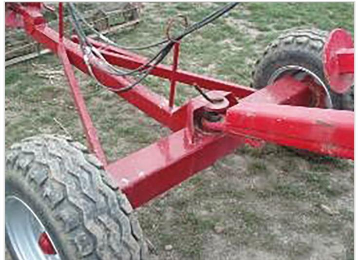
Dolly: Chariot avec roues permettant d'atteler un rouleau derrière le vibroculteur.
