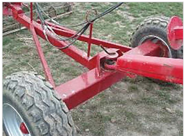
Dolly: Hjulsæt, der muliggør tilkobling af tromle bag harven – 11,5/80 x 15,3 hjul
