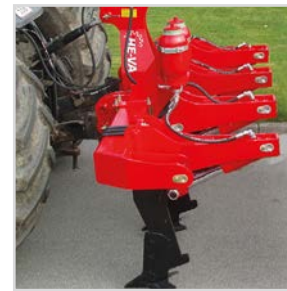
3,00 m med hydr. auto. udløser og 4 tænder
