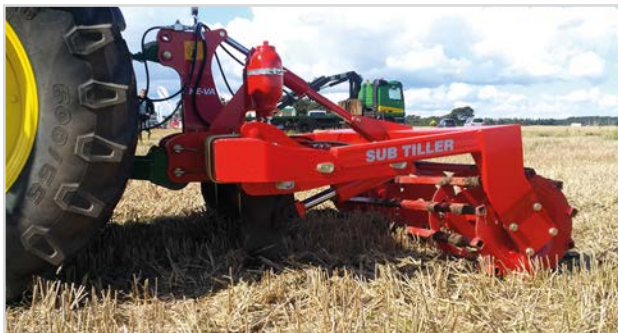
3,00 m med hydr. auto. udløser og 4 tænder
