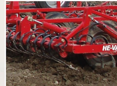
Élément indispensable dans la préparation d'un lit de semences parfaitement plat et émietté, la lame niveleuse frontale Spring-Board joue un rôle souvent ignoré. Le sol est nivelé et la majeure partie des mottes est éclatée par l'effet de percussion des lames de ressort de 10 x 45 mm équipées de socs palettes de 8 x 100 mm.
