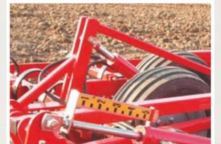
Un indicateur d'angle de travail, disposé sur la section latérale à droite, permet au chauffeur de visualiser facilement la position des lames Spring-Board.
