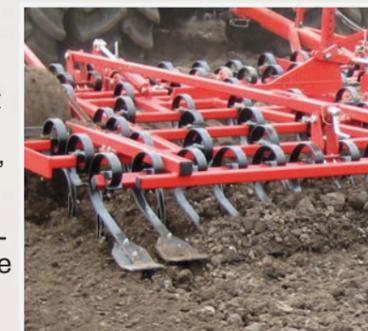
Les lames de la Spring-Board arrière sont reliées par une barre à la lame niveleuse avant, elles sont commandées conjointement par le même circuit hydraulique. Une manivelle permet cependant de modifier l'angle de travail des lames arrières indépendamment de la lame avant.
