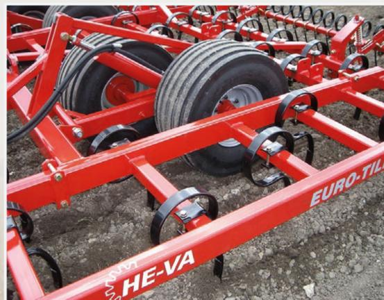
I robusti denti dell'erpice da 10 x 45 mm garantiscono un'erpatura ottimale di tutti i tipi di terreno.
