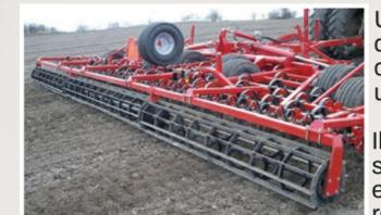
Un rullo a lame da Ø400 mm con davanti montato il post-erpice a denti lunghi lascia una superficie consolidata e frantumata. Con la sua costruzione in acciaio piatto da 8 x 40 mm, questo tipo di rullo garantisce una perfetta struttura del terreno.
