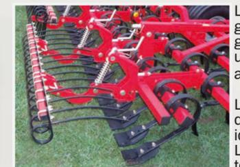
La livella Spring-Board posteriore è montata dietro la sezione dell'erpice e garantisce un efficace livellamento delle tracce dei denti dell'erpice e un leggero consolidamento del terreno. I denti vibranti rompono efficacemente le ultime zolle. La livella posteriore Spring-Board può essere montata insieme al post-erpice a pettine a denti lunghi.
