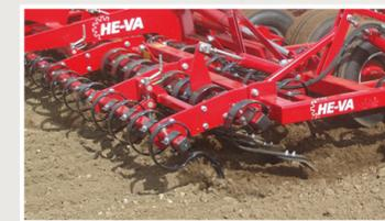
Con la barra erpicatrice anteriore montata davanti alla livella Spring-Board anteriore, la crosta, le tracce delle ruote o il terreno compattato vengono allentati in modo che la barra di livellamento esegua un livellamento più preciso di terreno già sollevato con un ridotto consumo energetico. Quando l'Euro-Tiller è dotato di barra erpicatrice frontale, la distanza media dei denti è di 6,4 cm. L'aggressività (angolo delle file dei denti) dell'erpice anteriore viene regolata tramite manovella.
