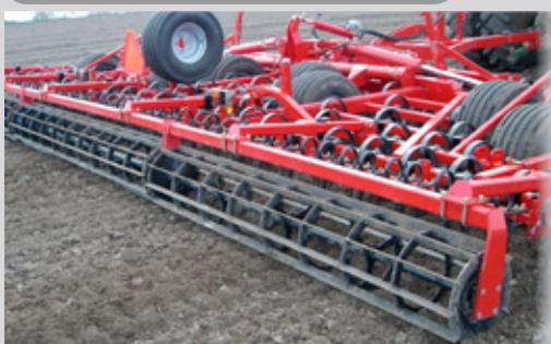
Hvis det monteres Ø400 mm spilevalse med langfingerharv foran valsen, legges såbedet svært finsmuldret med lett sammenpakket overflate. Valsen er laget av 12 stk. spiler av 8 x 40 mm flattjern, som etterlater en overflate med perfekt struktur.
