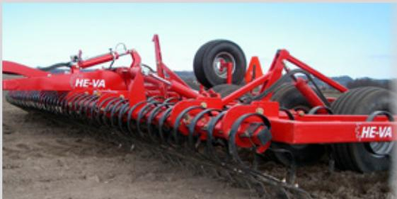
Spring-Board foran på Euro-Tiller planerer marka perfekt, og de største klumpene knuses. Spring-Board tinden er en kraftig 10 x 80 mm fjærtinde utstyrt med 8 x 150 mm spisser. Spring-Board har hydraulisk innstilling av aggressivitet/arbeidsdybde som kan justeres under arbeid.
