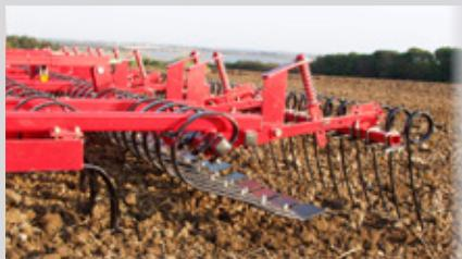
Spring-Board etterharv er sammenkoblet med fremre sloddeplanke som er hydraulisk justerbar. Forholdet mellom fremre og bakre springboard justeres med sveiv.
