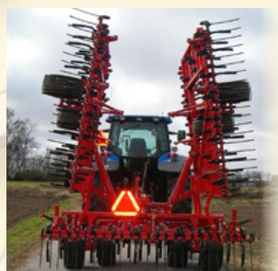
**I transportstilling** - løftes sideseksjonene opp innover mot midten for å bedre harvens stabilitet ved kjøring. En kraftig mekanisk transportlås sikrer sideseksjonene i transportstillingen, og låsen utløses automatisk ved hjelp av hydraulikken. Det kraftige hengsleleddet for sideseksjonene gir samtidig stor styrke, når harven er i arbeidsstilling.
