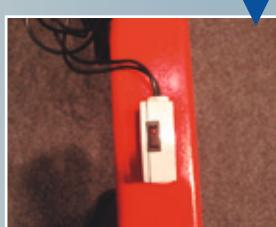
Harvedybden stilles enkelt inn sentralt ett sted på harven. Deretter sørger det elektriske dybdeanslaget for at harvedybden blir nøyaktig lik hver gang etter at harven har vært løftet opp. Dybdehjulenes 'master-slave'-hydraulikk sikrer at hjulene arbeider helt likt.
