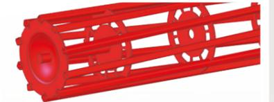
Die schwere Rohrstabwalze mit Ø550 mm ist aus einem starken Profilrohr hergestellt, was die Walze sehr widerstandsfähig gegenüber Steinen macht. Die schwere Rohrstabwalze sorgt für eine tiefe Rückverfestigung und hinterlässt eine lockere Bodenoberfläche.
