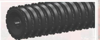
Die V-Profil-Packerwalze mit Ø600 mm sorgt für eine optimale Durchtrennung der Oberfläche und hinterlässt eine ideal rückverfestigte und vor allem witterungsbeständige Oberfläche. Das V-Profil ist ein gezahnter Ring aus gepresstem Stahl mit Schulterprofil, der für aggressive Zerkleinerung der Erdklumpen auf schweren Böden und eine optimale Rückverdichtung von leichteren Böden sorgt. Es gibt Schaber zwischen den Ringen, die unter allen Bedingungen eine wirksame Rückverfestigung gewährleisten.
