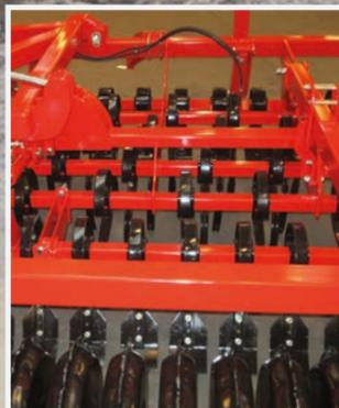
45x12 mm avec intervalle entre passage des dents de 8,5 cm, elle est recommandée pour les préparations fines et homogènes
