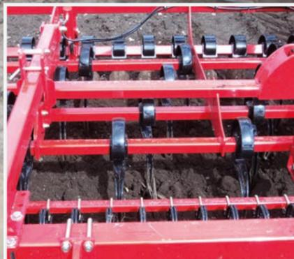
65x12 mm avec intervalle entre passage des dents de 15 cm, elle est conseillée pour un hersage plus espacé. Cette dent est adaptée à un déchaumage léger, et avec l'utilisation des socs pattes d'oie en 180x6 mm proposés en option, toute la surface est travaillée.
