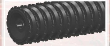
Le rouleau V-profil Ø600 est un bon émietteur qui rappuit en profondeur en laissant un aspect très légèrement billonné ce qui contribue à ce que le sol conserve une bonne capillarité. Les anneaux V-profil sont dentelés, en acier embouti avec un épaulement contrôlant la pénétration. Ces anneaux brisent les mottes résiduelles et retassent les sols lourds, et ils rappuient efficacement sur sols légers. Les décroisseurs entre les anneaux sont réglables et assurent un excellent décrassage.
