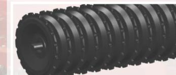
Il rullo packer da Ø600 mm taglia la superficie, lasciando un consolidamento ideale e, soprattutto, una superficie resistente alle intemperie. Il profilo a V da Ø600 mm è un anello seghettato in acciaio stampato con un profilo della spalla che rompe facilmente le zolle su terreni pesanti e consolida in modo efficiente i terreni più leggeri. Efficaci raschiatori montati tra gli anelli rendono possibile un consolidamento uniforme in tutte le condizioni del terreno.
