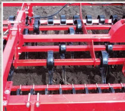
Denti da 65x12 mm con interfila di 15 cm per un'erpatura più leggera per mantenere la struttura della superficie. Questo dente permette di utilizzare l'erpice per la preparazione leggera con stoppie, un taglio completo della superficie è assicurato con la punta a zampa d'oca 180x6 mm.
