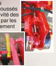
Le vibroculteur frontal avec 2 rangées de dents en S, réglables en hauteur, est adaptable sur tous les rouleaux poussés. 2 manivelles de réglage permettent de positionner les dents à la profondeur requise.
