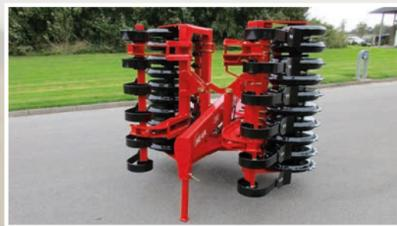
Front-Roller - 3,00 m - 2-sections - à repliage hydraulique
