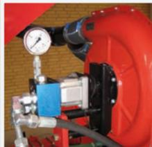
Der Ölbedarf des Hydraulikmotors liegt zwischen 10–20 l/min. Der Motor ist mit einem Sicherheitsventil ausgestattet, das ihn vor Überlastung durch zu hohen Öldurchfluss schützt.
