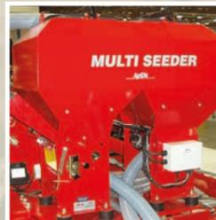
Der Multi-Seeder Twin verfügt über einen Tank mit zwei separaten Kammern und zwei Dosiereinheiten, wodurch eine unabhängige Einstellung der Saatmenge für jede Einheit möglich ist. Der Multi-Seeder Twin ist daher ideal für die Rapsaussa in Kombination mit Schneckenkorn. Standardmäßig ist der Multi-Seeder Twin mit einem Auto-Controller sowie einem Computer zur Steuerung beider Dosiereinheiten ausgestattet.
