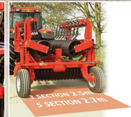
Eingeklappt liegt das Gewicht der Seitensegmente zwischen Schlepper und den Rädern der Walze – mit einer optimalen Gewichtsverteilung während des Transportes.
