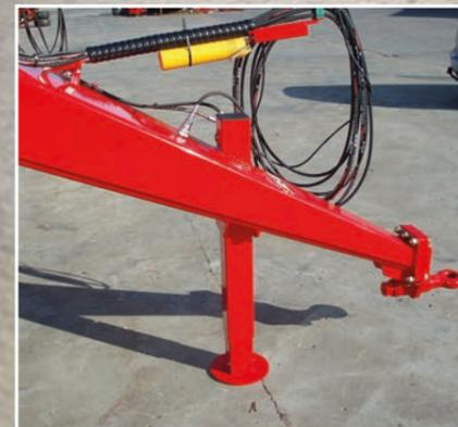
Bei 4,50 m - 8,20 m Tip-Rollern sind stufenlos verstellbare Stütze Standard. Hydr. Stütze sind Standard bei 9,50 und 10,20 m Tip-Rollern.
