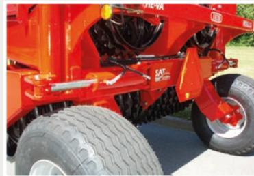
Alle 4,50 und 5,40 m Tip-Roller sowie 6,30 m Modelle mit Ringgrößen unter 600 mm sind mit einem Gewichtsausgleichssystem versehen, das aus einem Klappzylinder und am entgegengesetzten Ende einer Feder mit Teleskop besteht.
