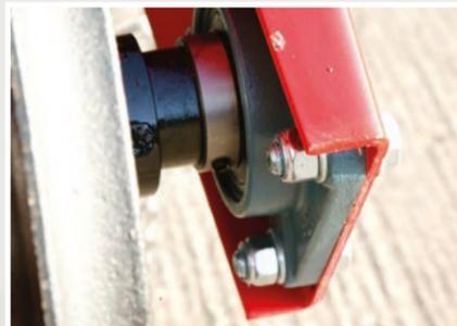
Die stabilen, verschleißarmen, unterschiedlichen Walzenringe werden von einer 60 mm starken Welle aus Spezialstahl getragen. Die beidseitigen Flansch-Kugellager mit Doppeldichtung sind geschützt im U-Profilrahmen mit 4 Schrauben montiert und garantieren somit eine lange Lebensdauer.
