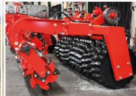
Das einzigartige Design mit geschlossenem Walzenkörper verhindert, dass sich Erde und Ernterückstände in der Messerwalze sammeln und zu Verstopfungen führen. Die Messer aus spezial gehärtetem Metall sichern ein hervorragendes Arbeitsergebnis und eine lange Lebensdauer.
