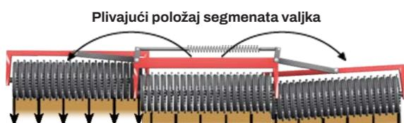
3 Kod HE-VA valjaka sa aktivnim opružnim sistemom i sa srednjim kačenjem sekcija za centralni deo, pritisak centralnog dela valjka se raspodeljuje na sekcije ravnomerno, čime se obezbeđuje ravnomerni pritisak preko cele radne širine.
