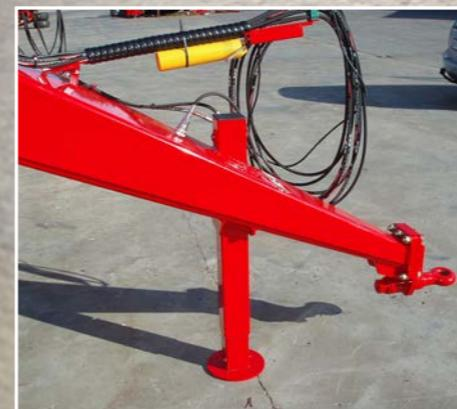
Ručno podešivi potporni nogar je standardan na 4,50 - 8,20 Tip-Valjcima. Hidraulično podešiv potporni nogar je standardan na 9,50 i 10,20 m Tip-Valjcima.
