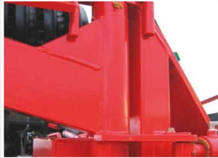
Osovina pravljena od specijalnog čelika sa prečnikom od 60 mm nosi valjkaste nehabajuće prstenove. Ležajevi su dvostruko zaptiveni i pričvršćeni sa četiri vijke za ram u obliku U-profila.
