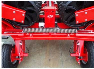
6,30 m Tip-Valjci sa 600/620 mm veličinom prstenova, svi 7,30 i 8,20 m Tip-Valjci su opremljeni sa dva cilindra za sklapanje (sa teleskopom u svakom kraju cilindra) i jakom oprugom koja se nalazi između dva cilindra.
