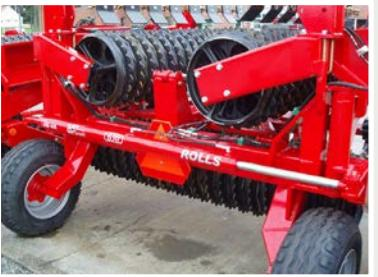
Svi 4,50 i 5,40 m Tip-Valjci i 6,30 m modeli sa prečnikom prstenova manjim od 600 mm su opremljeni sa sistemom prebacivanja težine, koji se sastoji od hidrauličnog cilindra i na drugoj strani oprugom sa teleskopom.
